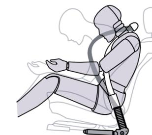
Cinturones de seguridad con doble pretensor y limitador de carga.
