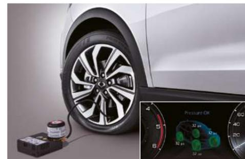
Sistema de control de presión de los neumáticos (TPMS) y Kit reparación de pinchazos.
