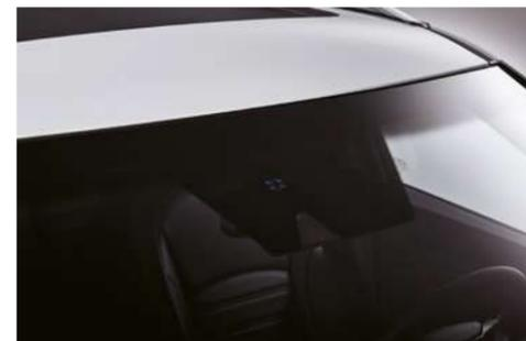
Parabrisas con sensor de lluvia y sensor de alumbrado automático.
