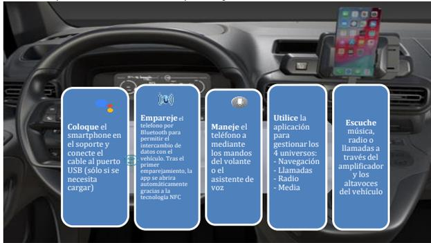
Una vez conectado con el smartphone, las siguientes funciones se controlarían con los mandos del volante a través de la aplicación MyPeugeot:
